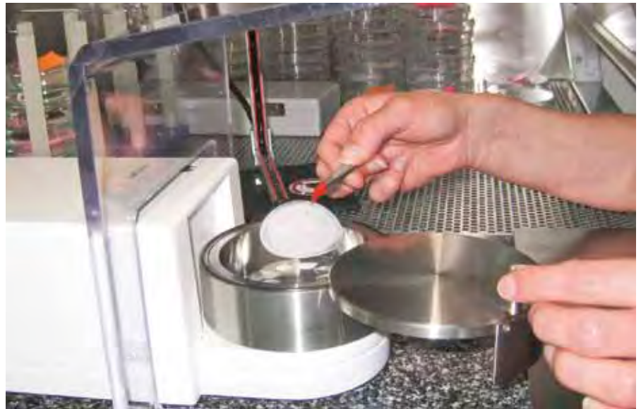
Zur Emissionsmessung wird der Gewichtszuwachs der Partikelfilter beobachtet.
